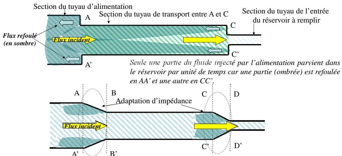
Le rétrécissement progressif du tuyau entre AA' et BB' limite le refoulement d'entrée et constitue l'adaptation d'impédance d'entrée tandis que celui entre CC' et DD' limite le refoulement à l'entrée du réservoir et constitue l'adaptation de sortie. Remarquons aussi l'équivalence entre impédance caractéristique et section du tuyau.....
