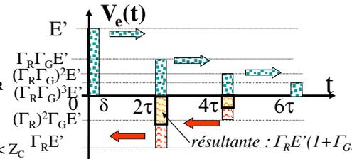
Le générateur « voit »  $Z_c$  entre A et B à  $t=0$  donc  $E' = 2Z_cE/(Z_G+Z_c) > E$  si  $Z_G < Z_c$
