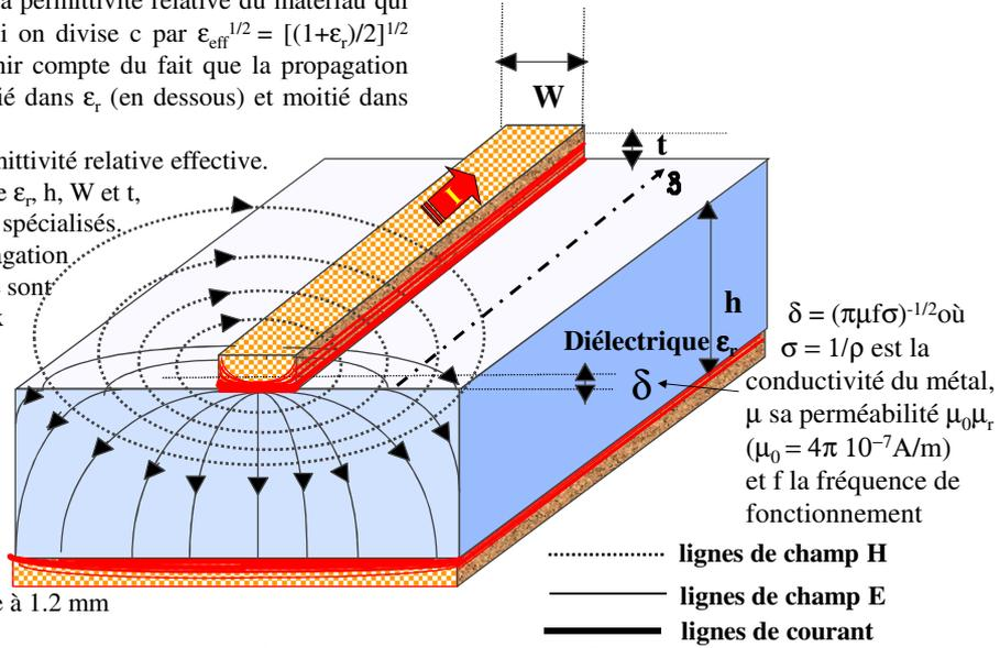
Attention : échelle non respectée vis à vis des épaisseurs de métallisation par rapport à celle du diélectrique !
