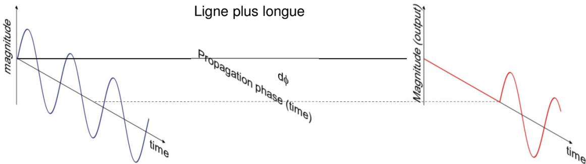
Conséquences de la propagation d'un signal sur une ligne de transmission : **bossier ce cours !**
