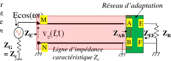
Dans ces conditions, toute la puissance délivrée par le générateur pénètre dans le réseau puisque la ligne est chargée sur  $Z_c$ , entre A et B, et le réseau d'adaptation (dont la sortie EF se comporte comme un générateur d'impédance interne  $Z_{EF}$ ) restitue toute cette puissance (il est sans perte) à la charge (car  $Z_{EF} = Z_R^*$ ) : comment réaliser ce réseau ?
