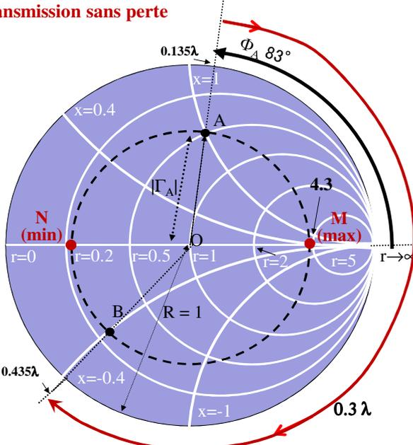
4- le point M correspond à un maximum de tension sur la ligne et N à un minimum
