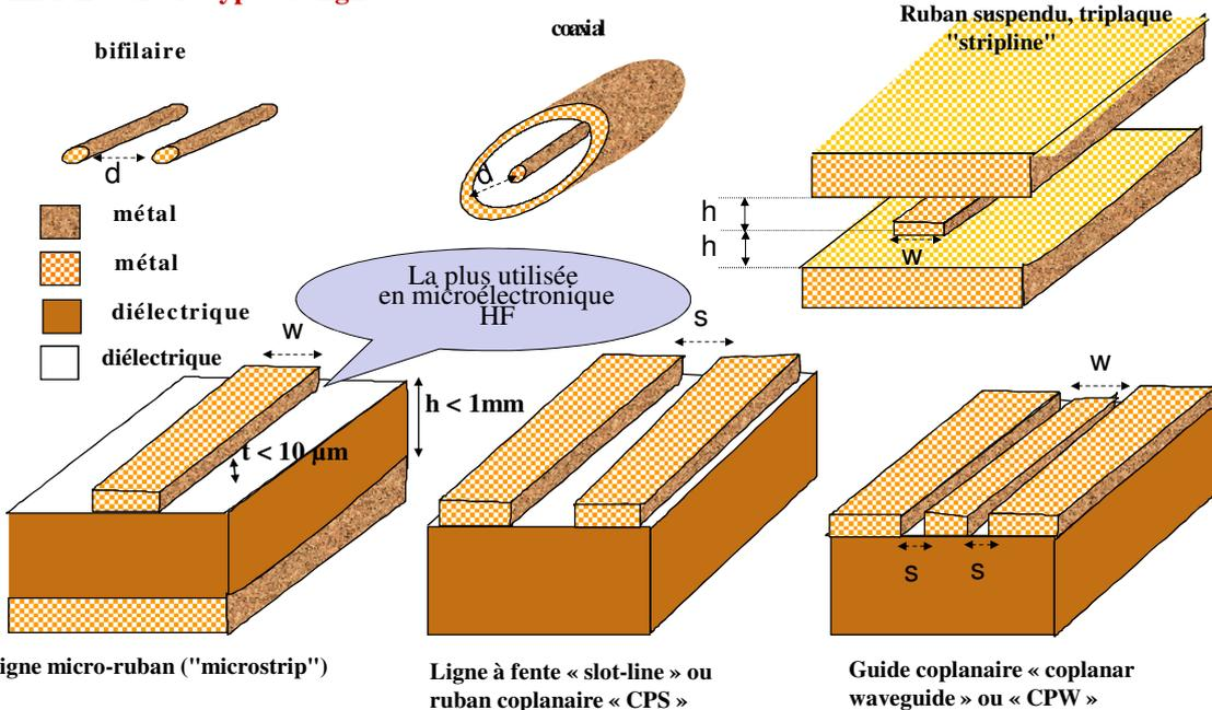
Attention : échelle non respectée vis à vis des épaisseurs de métallisation par rapport à celle du diélectrique !
