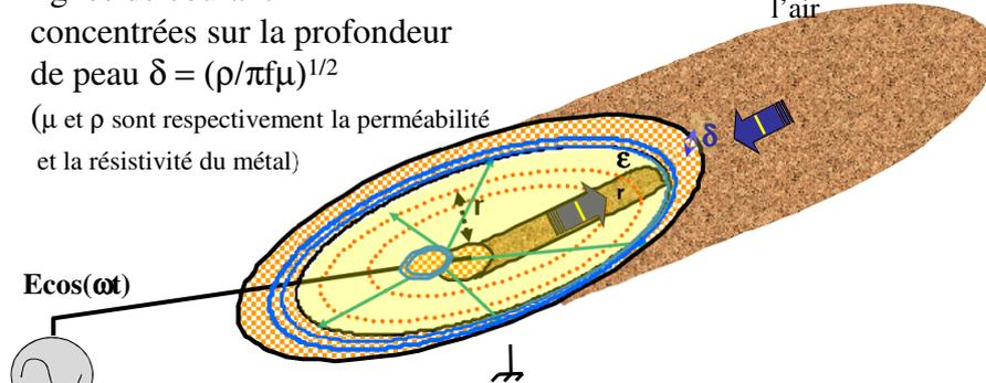
Ce type de ligne est utilisable jusqu'à plus de 100 GHz à condition que son diamètre soit suffisamment faible ( $r < 1\text{mm}$  pour dépasser 100 GHz ce qui implique un coût élevé).
