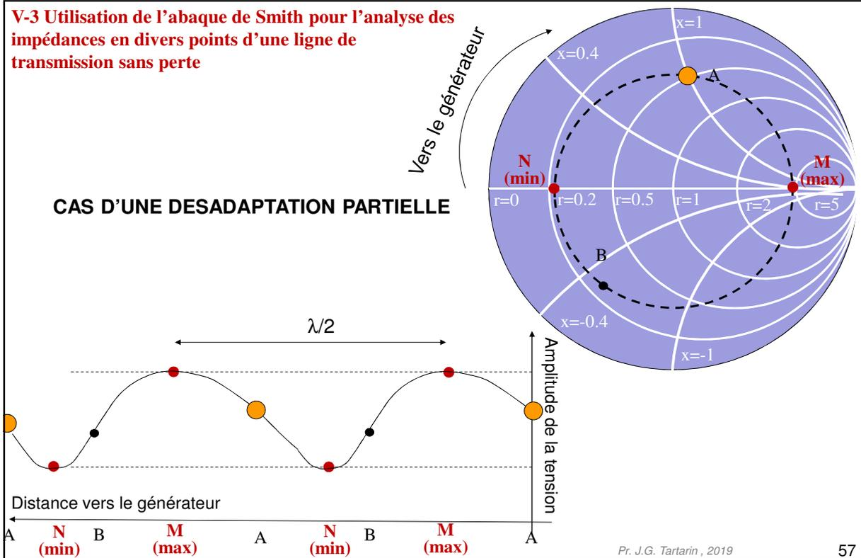
**V-3 Utilisation de l'abaque de Smith pour l'analyse des impédances en divers points d'une ligne de transmission sans perte**
