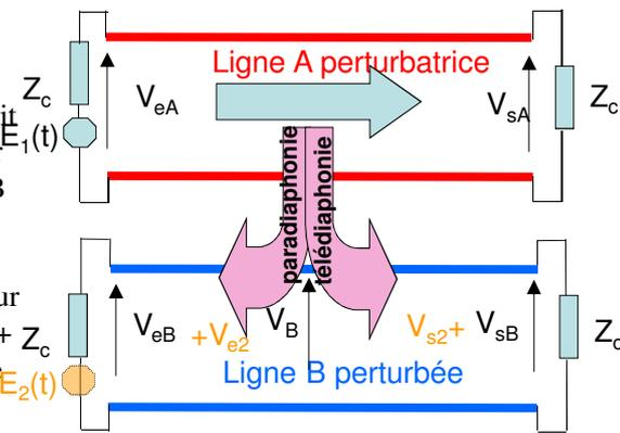
Ce phénomène est *gênant* car la ligne B peut elle-même être alimentée pour transporter un signal donnant des tensions utiles  $V_{e2}$  et  $V_{s2}$  aux extrémités : lorsque les tensions parasites  $V_{eB}$  ou  $V_{sB}$  se superposent sur les signaux utiles, elles peuvent les perturber gravement.
