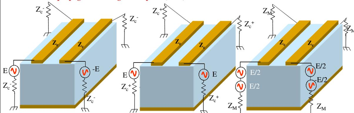
On alimente les deux lignes couplées avec des générateurs d'égales amplitudes mais en opposition de phase (alimentation en mode **impair/différentiel**) : les lignes sont adaptées (pas de réflexion sur la charge) si elles sont chargées par  $Z_c^-$ .
