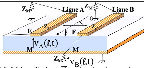
Deux lignes A et B étant placées à proximité ( $k$  faible  $\ll 1$ ), des modes pair et impair apparaissent sur chacune dès que A est excitée. Etudions d'abord les conséquences de l'existence de ces modes sur la propagation de l'impulsion dans A.
