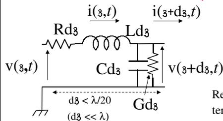
L'équation (4) s'écrit encore  $d^2v/d_3^2 = RGv + (RC+LG)(dv/d_3) + LC(d^2v/d_3^2)$  (5) et est appelée *équation des télégraphistes*. Elle dispose d'une équation duale en courant :  $d^2i/d_3^2 = RGi + (RC+LG)(di/d_3) + LC(d^2i/d_3^2)$  (6)
