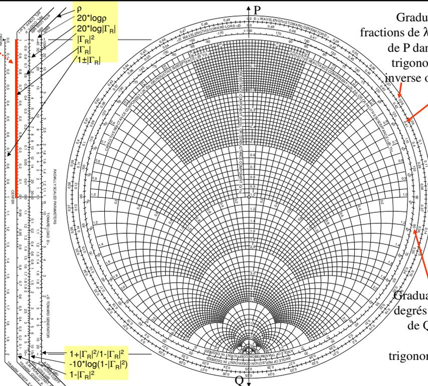
Graduations en fractions de  $\lambda$  (à partir de P dans le sens trigonométrique inverse ou direct)
