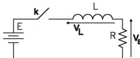
À l'instant  $t = 0$ , on ferme l'interrupteur  $k$ . À cet instant le courant dans le circuit est nul.
